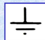
Gli impianti con la messa a terra hanno un terzo filo, di colore giallo e verde, che scarica nel terreno la corrente in caso di guasto.
