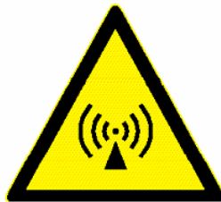
Figura 1: segnaletica di presenza di radiazioni elettromagnetiche che possono generare condizioni di esposizione non accettabili.
